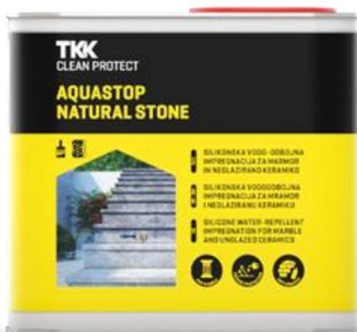
Vodoodbojne impregnacije su najefikasnije na površinama sa kojih voda može da otiče, pa se najčešće koriste za zaštitu vertikalnih i kosih površina, odnosno površina sa odgovarajućim nagibom od 3-5 %. Zaštićene površine ostaju paropropusne, tj mogu da „dišu“.
