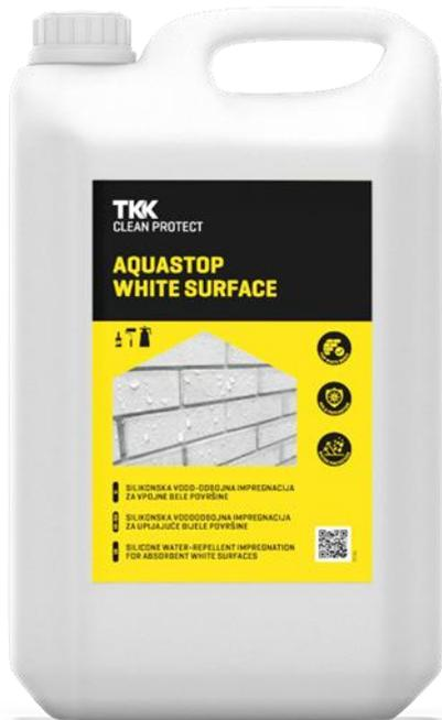
Aquastop White Surface este o soluție incoloră, pe bază de siliconat, pentru protecția finală a materialelor anorganice poroase [absorbante] împotriva apei și a umezelii. Datorită absorbției sale excelente, pătrunde adânc în porii materialului și, odată ce apa s-a evaporat, formează o impregnare de suprafață invizibilă, fără peliculă.
