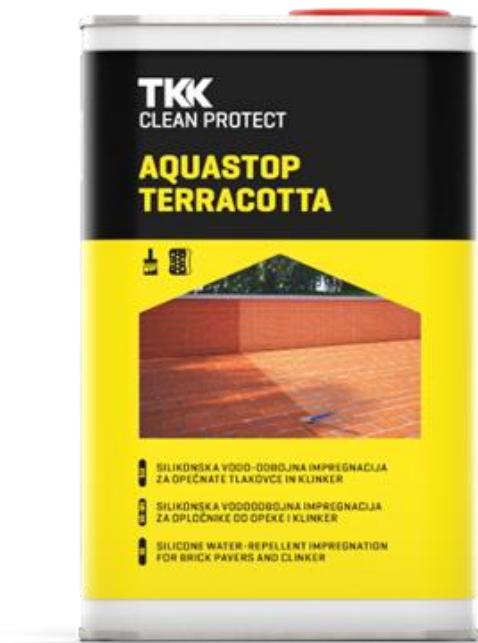
Aquastop Terracotta je tekućina na bazi silan-silosana i lanenog ulja namijenjena za završnu zaštitu poroznih (upijajućih) anorganskih materijala, posebno neglaziranog klinkera i opeke za popločavanje (terakota), od vode i vlage. Zbog izvrsnog upijanja prodire duboko u pore materijala i nakon isparavanja otapala stvara nevidljivu impregnaciju površine bez stvaranja filma.
